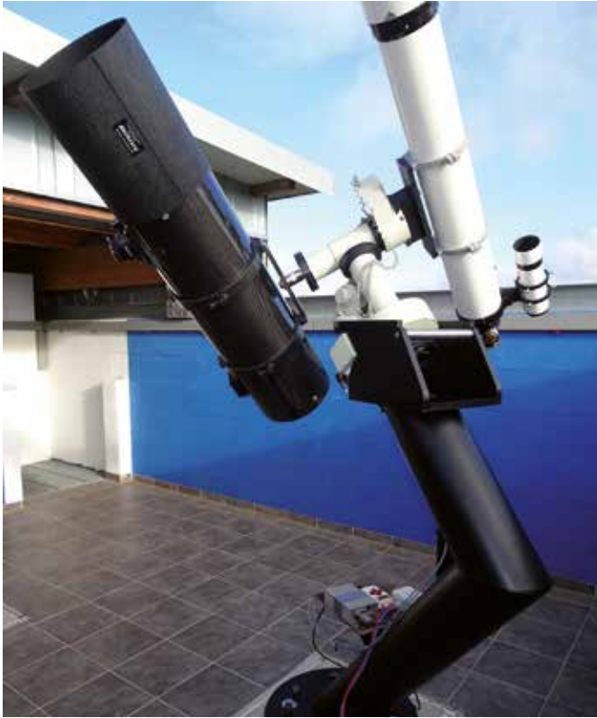
4 Knicksäule mit zwei Teleskopen gegenüberliegend auf der Deklinationsachse montiert. Dank der Knicksäule lassen sich die Teleskope völlig frei in alle Richtungen schwenken.
