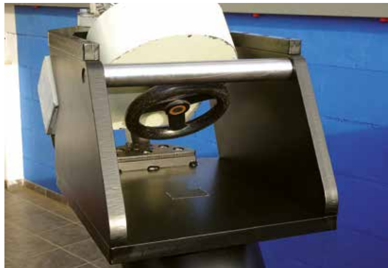
3 Detailansicht des oberen Aufbaus der Knicksäule von Süden. Das Klemmrad der Rektaszensionsachse ist weiterhin gut zugänglich.
