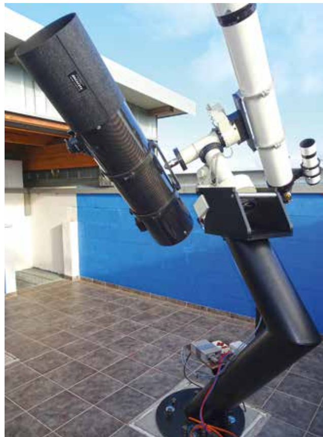
1 Newton-Reflektor 250 mm/1.000 mm auf Knicksäule (Johann-Kern-Sternwarte Wertheim, rechts 6-Zoll-Refraktor)
